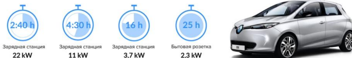
Рисунок 14 – Время зарядки на примере Renault ZOE (ёмкость аккумулятора 41 кВт·ч)
