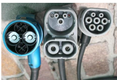
Рисунок 6 – Зарядное устройство типа CHAdeMO
