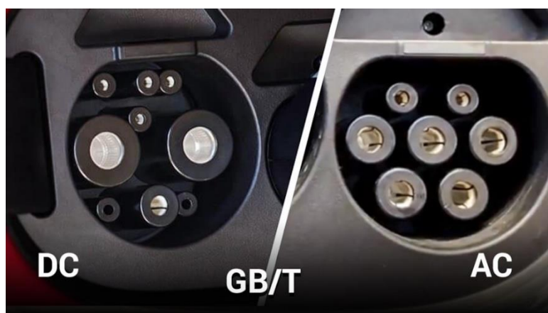
Рисунок 11 – Стандарт зарядной станций GB/T переменным и постоянным током
