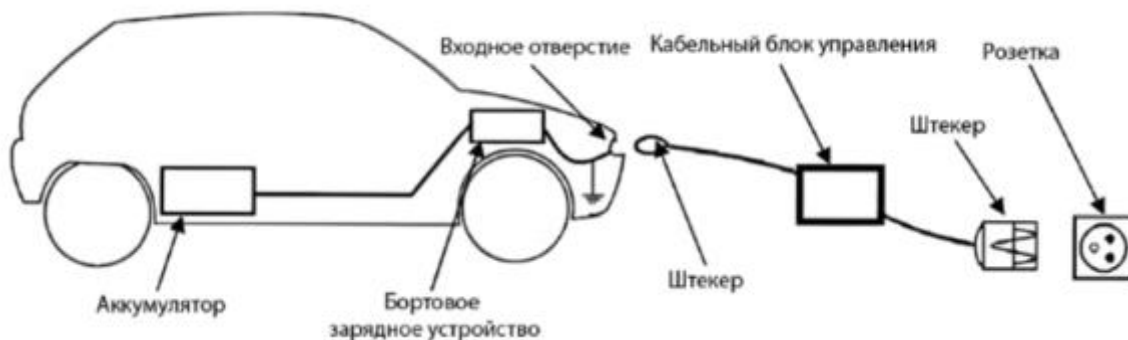
Рисунок 3 – Зарядка автомобиля в режиме 2
