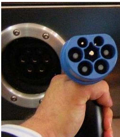
Рисунок 9 – Розетка для зарядной станции переменного тока GB/T и штекер соединительного кабеля (синий). Для обоих концов соединительных кабелей используется штекерный интерфейс
